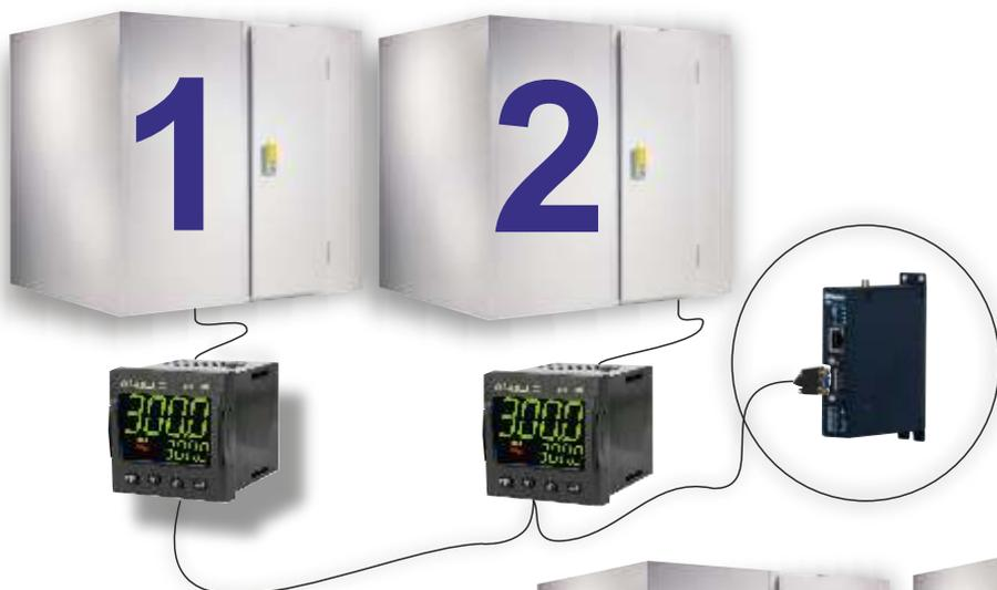
Sistema pasarela IIOT para conectar cualquier elemento con una conexión MODbus tanto sea Ip como RTU
